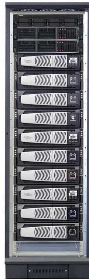
Gracias al nuevo bypass modular MBB SDU, dedicado a la serie Sentinel Dual SDU, los modelos SDU de 5, 6, 8 y 10 kVA/kW pueden conectarse en paralelo hasta un máximo de 3 unidades (del mismo modelo de potencia) para aumentar la capacidad global del sistema, o configurarse para funcionar en modo N+1 para aumentar la protección y fiabilidad del sistema crítico.
